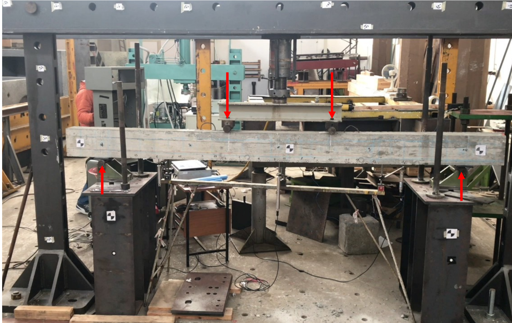
TEST su travi in calcestruzzo armato
