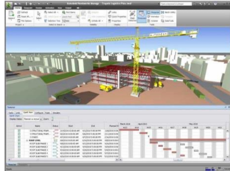
IL CANTIERE VIRTUALE: 4D BIM
