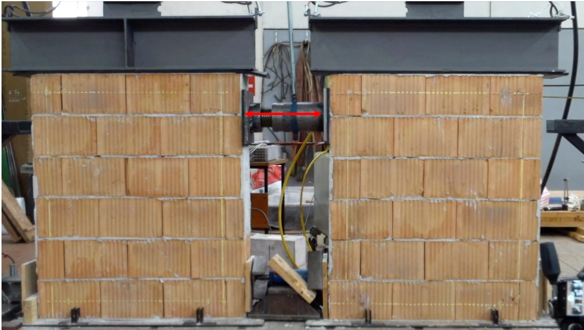
Prova di carico quasi statico su pannelli in muratura soggetti a taglio / azione normale
